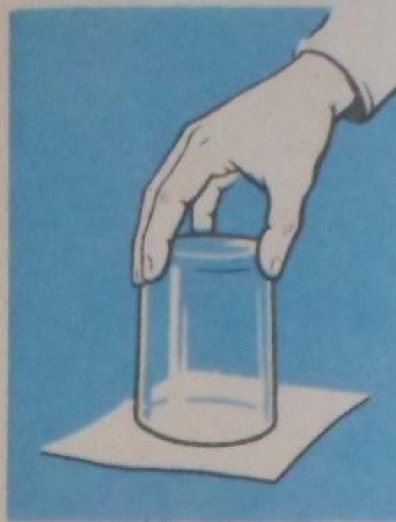
Рис. 111. Атмосферное давление прижимает лист бумаги к краям стакана, и вода не выливается.
