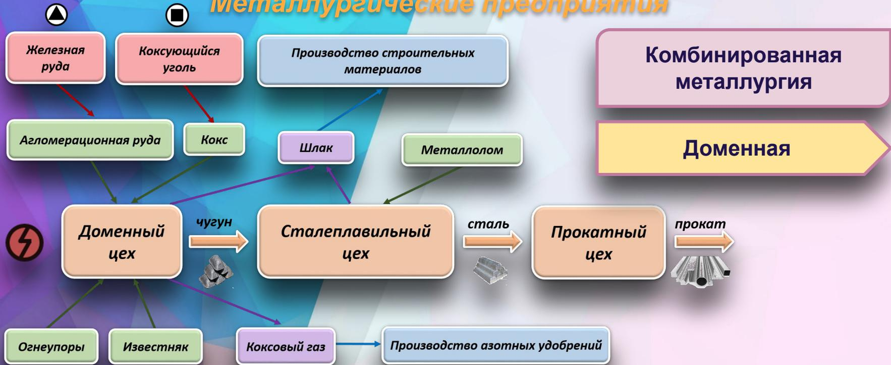
Комбинаты (металлургические заводы полного цикла) — это совокупность предприятий от добычи руды до изготовления проката. Размещаются комбинаты непосредственно около месторождений железной руды или коксующегося угля.
