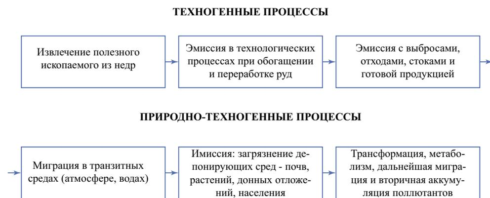
Рис. 1.3. Схема техногенных и природно-техногенных геохимических процессов при добыче и переработке полезных ископаемых (Солнцева, 1982)
