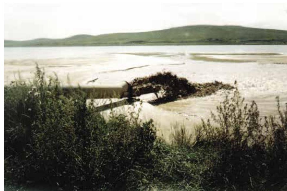
Рис. 2.13. Отходы подземного выщелачивания урановых руд на Стрельцовском месторождении, Читинская область (фото И.В. Чуднявцевой)
