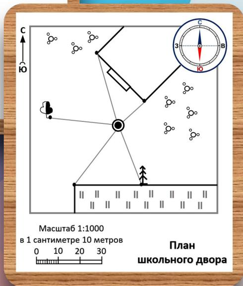
3. Стоя в выбранной точке, смотрим, какие объекты находятся на местности. Затем, учитывая примерное расстояние до объекта — какой ближе, какой дальше, отмечаем на плане их примерные границы. Обозначаем объекты условными знаками.
