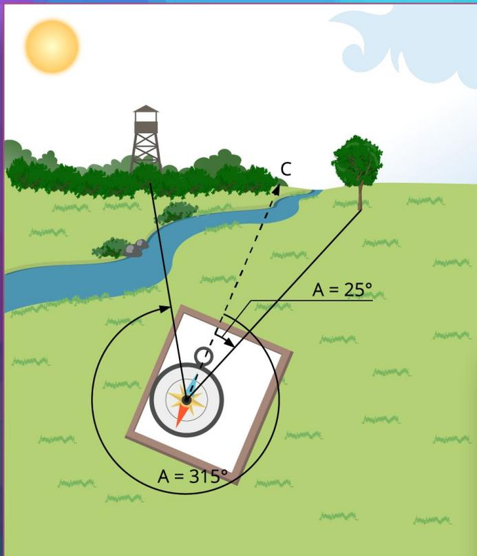
Можно научиться самому составлять простые планы местности. Составление плана «на глаз» без сложных и специальных приборов называется **глазомерной съёмкой местности**. Существует несколько несложных способов создания плана местности с помощью глазомерной съёмки.
